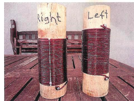
Afb. 1 RH en LH-helix van EA3HMJ op de wikkelvormen
